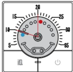
**Шаг 3:** Установите вращающуюся ручку обратно, таким образом, чтобы температурная отметка нанесенная на ручке, была расположена внутри ограниченной штифтами области.
