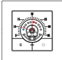
**Шаг 2:** Вставьте красный и синий штифты в отверстия, расположенные под температурной шкалой, чтобы задать нужный диапазон регулировки.
