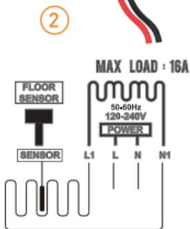
2. Подключите провода к клеммнику терморегулятора, согласно схеме:
